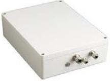
VIDEOJET connect 7000   HighPoE Versorgung für MIC7000 inklusiv Kombistrahler   Netzwerkanschlüsse: 1 HiPoE, 1 non-PoE, 2 SFP Steckplätze   integrierter Switch   integrierter Transcoder zur Übertragung von HD-Video über schmalbandige Netzwerke   Steckplatz für CF-Karte zur lokalen Aufzeichnung   Alarm Ein- und Ausgänge   IP67   Spannungsversorgung 120/230V AC   -40..60°C | A     |      | 1A   | 1.518,78         |
