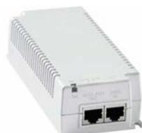
HighPoE Midspan zur Versorgung von AUTODOME IP inklusiv Heizung oder MIC 7000 ohne Kombistrahler | 60W | Spannungsversorgung 100..240 VAC, 50/60 Hz | Montage im geschützten Bereich | integrierter Überspannungsschutz
