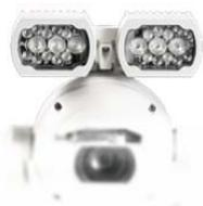
Kombinierte Infrarot/Weißlichtstrahler | IR 940nm im Nahbereich, 850nm im Weitbereich, umschaltbar auf Weißlicht 6700 K | IR Detection: 300 m/175m, IR Klassifikation: 250m/150m, IR Erkennung: 200m/100m, IR Identifikation: 75m/60m, Klassifikation Weißlicht: >150m/>125m | Öffnungswinkel IR: 15/30° hor/vert. | Öffnungswinkel Weißlicht: 13/25° hor/vert.
